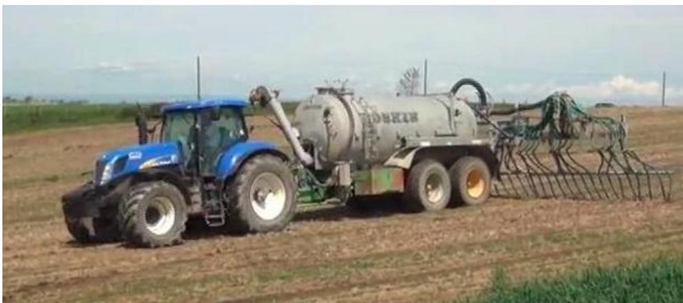
Les utilisateurs de tonne à lisier équipée d'une rampe à pendillard affirment très souvent que ce système couplé avec un retournement de la terre dans les 6 ou 12 heures donne de bons résultats en termes de diminution des odeurs et des émissions d'ammoniac. C'est vrai, mais ils oublient de signaler que les épandages de printemps se font très souvent sur cultures déjà en place et que bien sûr, il n'y aura pas de retournement de la terre ! C'est le cas à Heuringhem.
